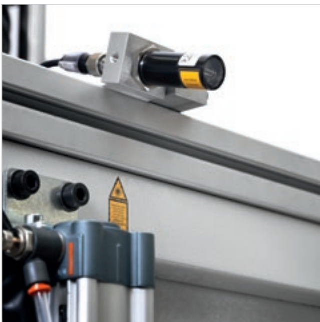
Plattenfluchtungssystem über in die Portalstruktur eingebauten Linienlaser.
