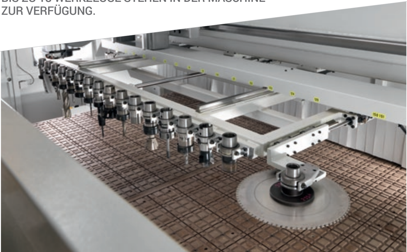
Lineares Werkzeugmagazin mit 17 Plätzen für einen schnellen Werkzeugwechsel.
